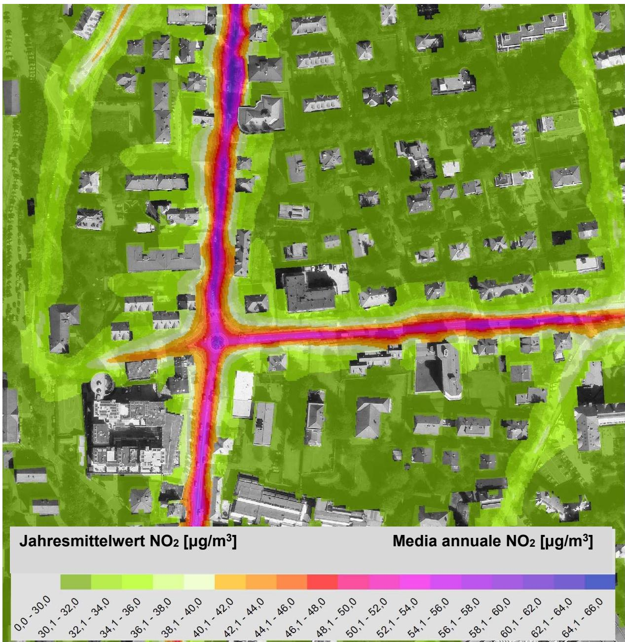
Abb. 5: MISKAM-Berechnung des NO<sub>2</sub>-Jahresmittelwert
