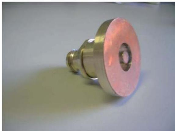
**Figura 2.2.2.4** - *Flangia per la procedura di misura standard modificata.*
