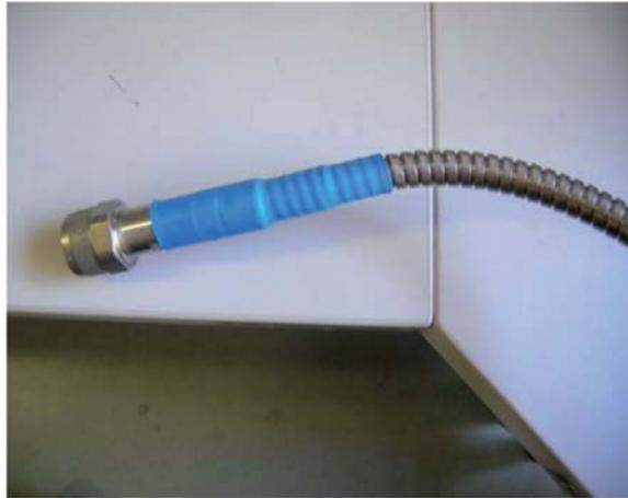
**Figura 2.2.2.3** - *Connettore di tipo N.*
