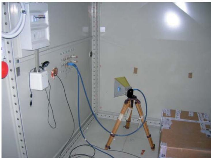
**Figura 2.3.3** - Interno della camera con antenna Horn ricevente.
