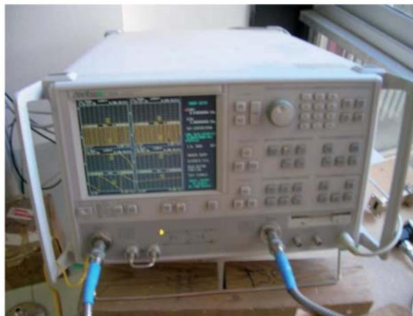
**Figura 2.2.2.2** - Analizzatore di rete.
