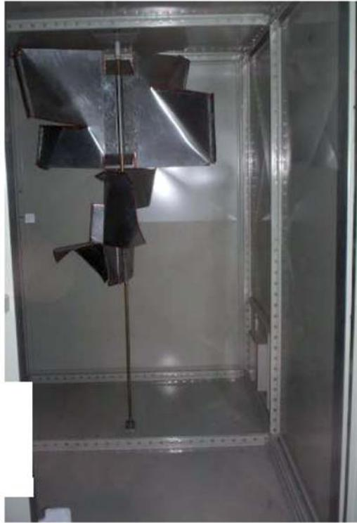
**Figura 2.3.2** - Foto dell'interno della camera riverberante con stirrer.
