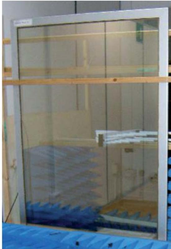
**Figura 1.2.1** - *Set-up di misura della finestra con cornice di alluminio e con la pellicola Century Nova 50 (F3, tipologia B) nel laboratorio EMC.*
