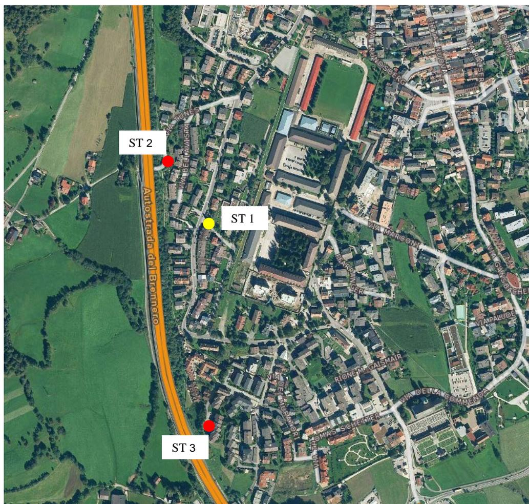
Fig. 5.5.1 – Posizione dei punti di misura ST1 (stazione fissa), ST2 e ST3 (campionatori passivi)
