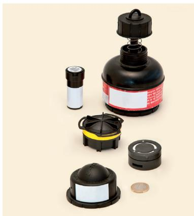
Apparecchiature per la misurazione della concentrazione di radon
