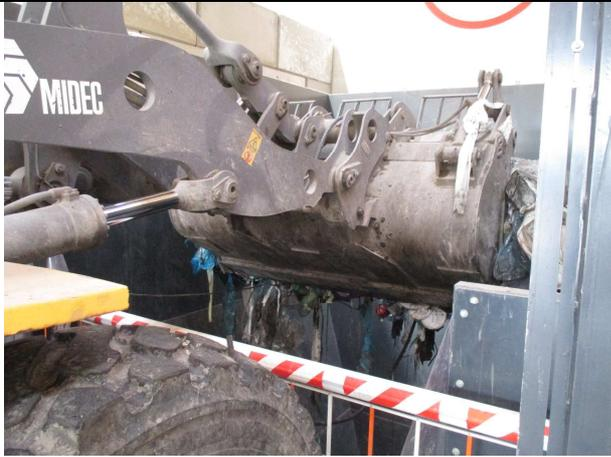
Einfüllung Trichter mittels Radlader
