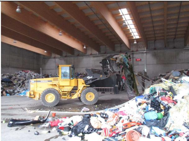
Einfüllung von Sperrmüll mittels Radlader
